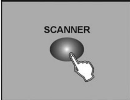
3. Durch Drücken der Scanner Tasten können Sie sich die Pan- und Tilt-Kanäle des jeweiligen Scanners anzeigen lassen.
