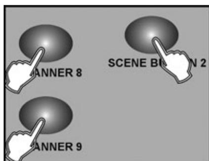
1. Drücken Sie bei ausgeschaltetem Gerät gleichzeitig die Tasten SCANNER 8, SCANNER 9 und SCENE 2.
