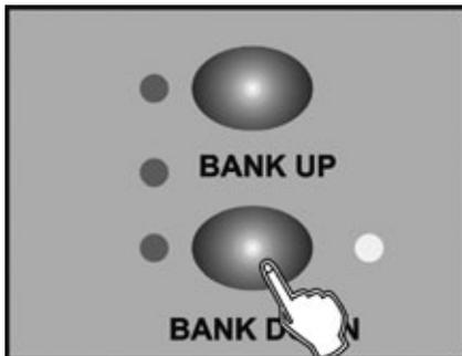
3. Mit den BANK UP/DOWN-Tasten wechseln Sie zwischen Pan und Tilt. Die entsprechende LED zeigt Ihre Auswahl an.
