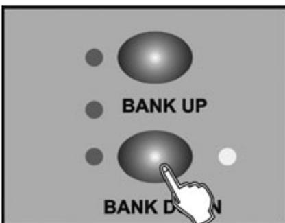
3. Verwenden Sie die Tasten BANK UP/DOWN, um zwischen Pan und Tilt zu wechseln.
