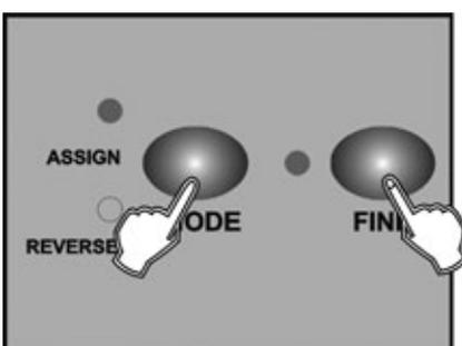
1. Drücken Sie gleichzeitig die Tasten MODE und FINE - die ASSIGN LED leuchtet.
