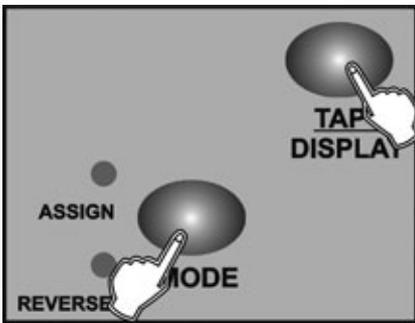
3. Drücken Sie gleichzeitig die Tasten TAP/DISPLAY und MODE, um die Einstellung zu speichern. Wenn Sie nicht speichern möchten, drücken Sie die BLACKOUT-Taste, um den Modus zu verlassen.
