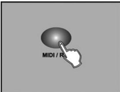
5. Drücken Sie die Taste MIDI/REC, dann zeigt die Anzeige eine um eine höhere Schrittzahl, als zuvor. Wenn Sie z.B. einen Schritt zwischen den Schritten 3 und 4 einfügen wollen, und Sie zu Schritt 3 scrollen, zeigt die Anzeige „STEP 004“ an, wenn Sie die Taste MIDI/REC drücken.
