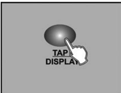
4. Verwenden Sie die Taste TAP/DISPLAY, um zwischen 8-Kanal und 16-Kanal Modus zu wechseln.
