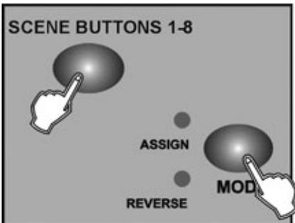
7. Während Sie die MODE-Taste gedrückt halten, drücken Sie die SCENE-Taste. Alle LEDs sollten kurz aufblinken und so anzeigen, dass der DMX-Kanal invertiert wurde. (die SCENE-Taste 1 steht für den DMX-Kanal 1, SCENE-Taste 2 für DMX-Kanal 2, und so weiter.)
