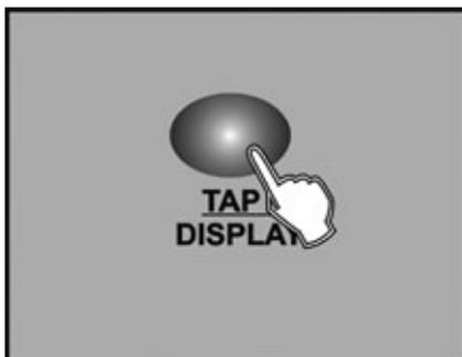
4. Drücken Sie die Taste TAP/DISPLAY, um zwischen dem 8-Kanal- und 16-Kanal Modus zu wechseln. Die LCD-Anzeige zeigt folgendes:
