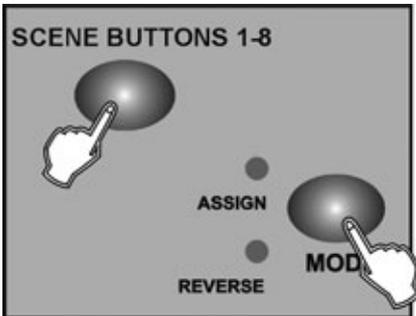
7. Während Sie die MODE-Taste gedrückt halten, drücken Sie die SCENE-Taste. Alle LEDs sollten kurz aufblincken und so anzeigen, dass der DMX-Kanal zugewiesen wurde. (die SCENE-Taste 1 steht für den DMX-Kanal 1, SCENE-Taste 2 für DMX-Kanal 2, und so weiter.)
