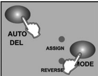
3. Drücken Sie gleichzeitig die Tasten AUTO/DEL und Mode. Alle LEDs blinken kurz auf, um den Löschvorgang zu bestätigen.
