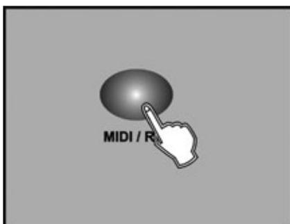
1. Halten Sie die MIDI/REC-Taste drei Sekunden lang gedrückt. Im Display wird der zuletzt eingestellte MIDI Kanal angezeigt.
