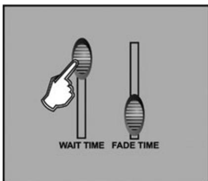
3. Mit dem WAIT TIME Regler (oder der TAP SYNC-Taste) und dem FADE TIME-Regler stellen Sie die Chase wie gewünscht ein. Sie können mehrere Chases gleichzeitig auswählen. Die Chases laufen in der Reihenfolge ab, in der Sie sie auswählen.
