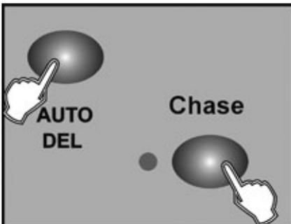
2. Halten Sie die Taste AUTO/DEL gedrückt, während Sie die CHASE-Taste drücken. Alle LEDs blinken dreimal kurz auf und zeigen so an, dass die Chase gelöscht worden ist.
