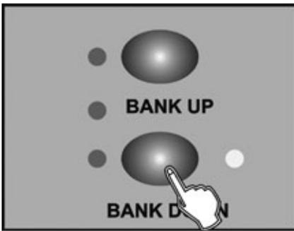
4. Wählen Sie anschließend mit den BANK UP/DOWN-Tasten die Bank aus, auf die kopiert werden soll.
