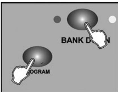
1. Drücken Sie bei ausgeschaltetem Gerät gleichzeitig die Tasten BANK DOWN und PROGRAM.
