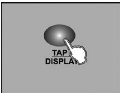
2. Schalten Sie das Gerät wieder ein. Drücken Sie die Taste TAP/DISPLAY, um zwischen „Fade Time“ und „Assign Fade Time“ zu wechseln. Das Display zeigt die folgende Meldung:
