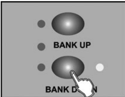
4. Drücken Sie die Taste BANK UP/DOWN, um zu den Schritt zu scrollen, hinter dem Sie einen Schritt hinzufügen möchten.
