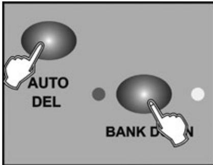
1. Halten Sie bei ausgeschaltetem Gerät gleichzeitig die Tasten AUTO/DEL und BANK DOWN gedrückt.
